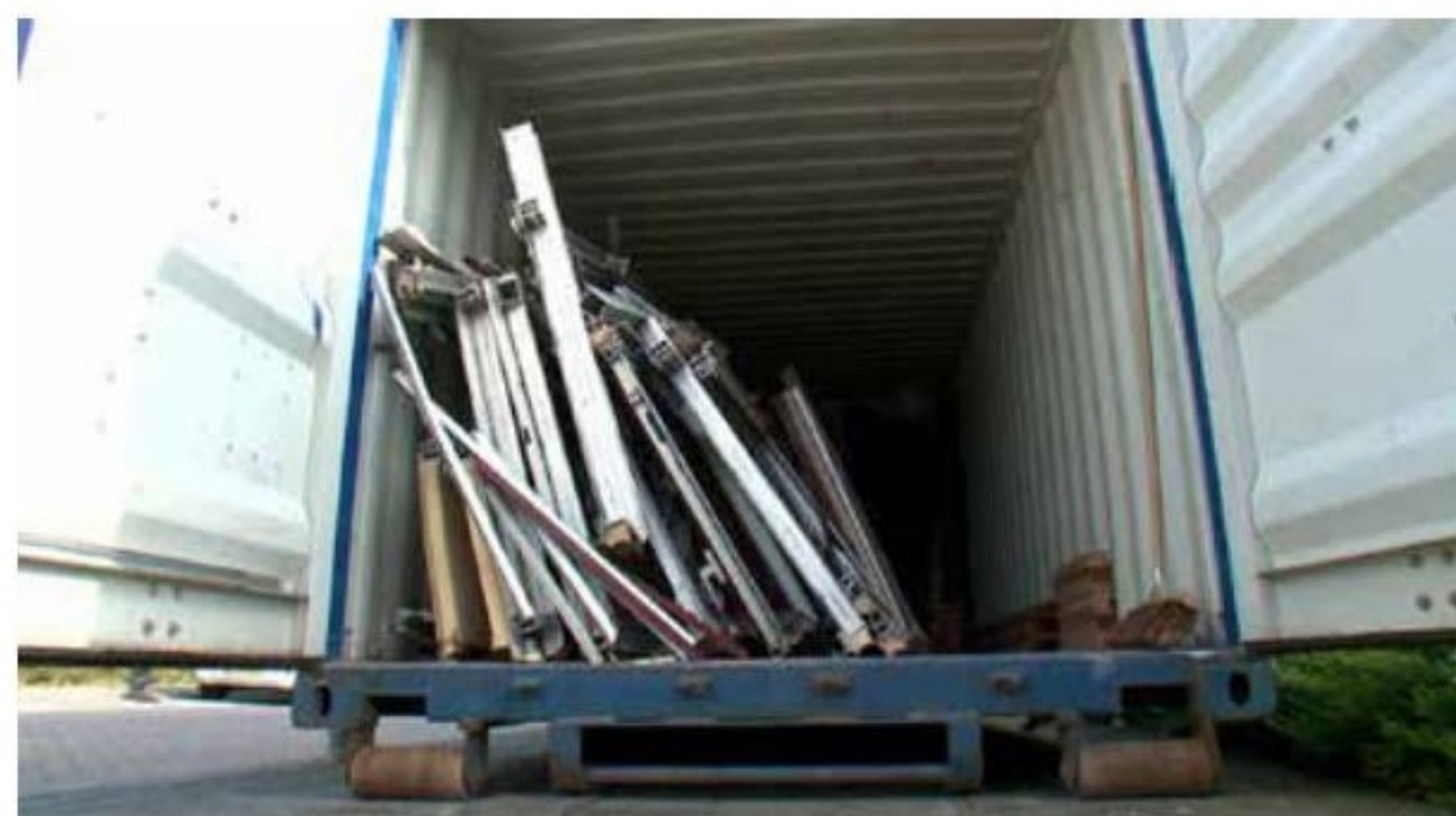
Gedemonteerde aluminium kozijnen, klaar voor recycling.
